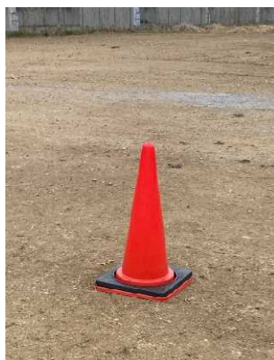
図 9 点群合成用の一時標識の例
